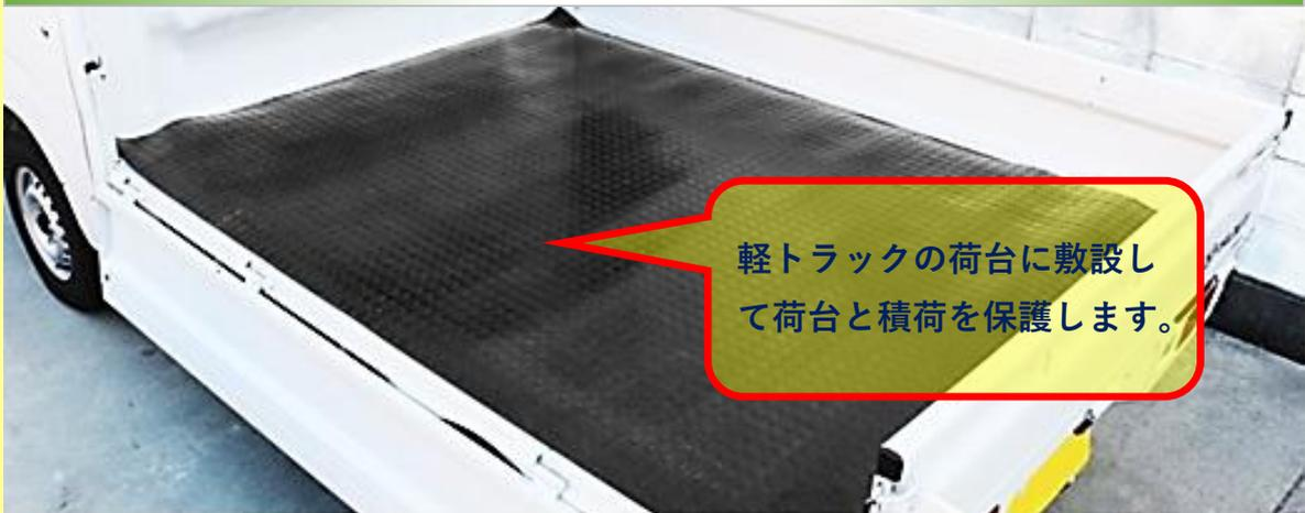
軽トラックの荷台に敷設して荷台と積荷を保護します。
